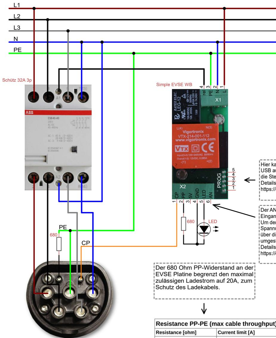
Hier kann optional ein Bluetooth Modul oder ein USB auf UART Kabel angeschlossen werden, um die Steuerung zu konfigurieren.
